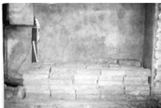
Fig. N° 4 Ecoladrillo listo para la construcción de bancales y posible comercialización
