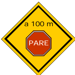
Fig. I-2-d Señal P.33(a) PROXIMIDAD SEÑAL RESTRICTIVA
