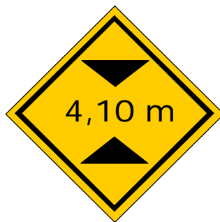
Fig. I-2-b Señal P.18 ALTURA LIMITADA
