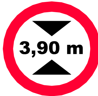
Figura N° I-44: Señal R.12 ALTURA LIMITADA
