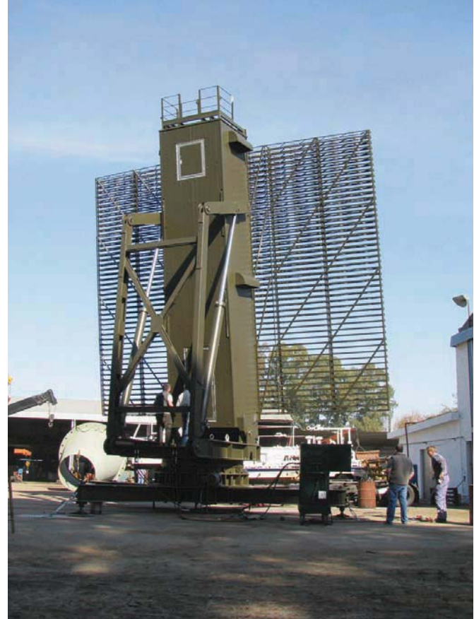
MET. En esta etapa se prueban la estructura y motorización del Radar Primario Argentino 3-DLA.
