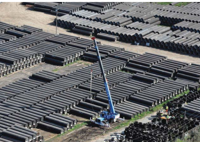
Playa de almacenaje de tubos de fundición nodular (DN 1200 mm).
