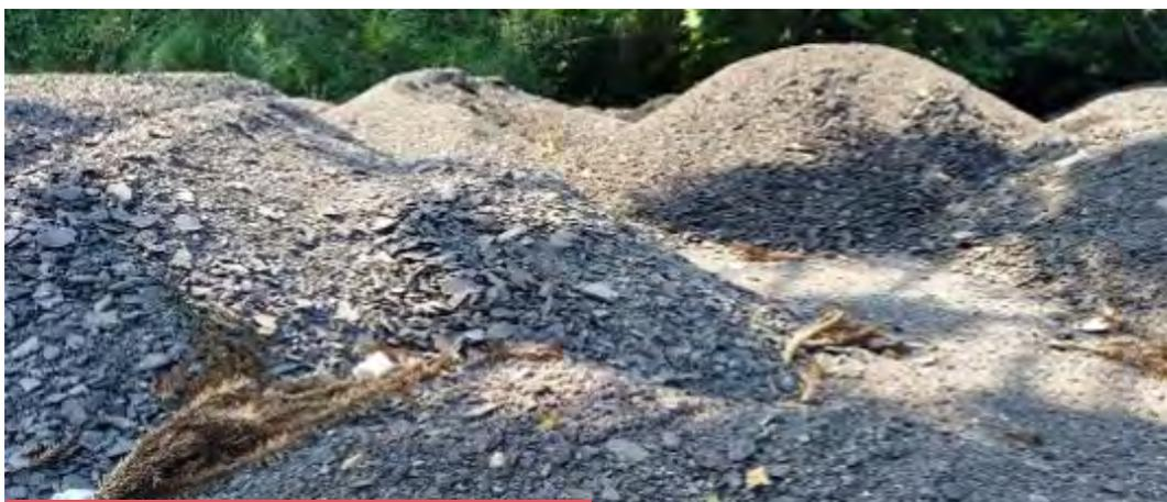
Figura 36. Material fresado
