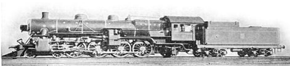
Locomotora de los Ferrocarriles del Estado Argentinos , construida por Baldwin Locomotive Works, para el servicio pesado en los ferrocarriles de vía ancha del gobierno, sección Huapi-Viedma en la provincia de Río Negro. Alimentada por petróleo.
