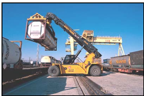
Transbordo de carga mediante apiladora
