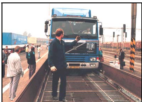
Proceso de carga de una carretera rodante
