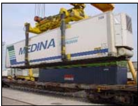
Operaciones de carga y descarga de cajas móviles
