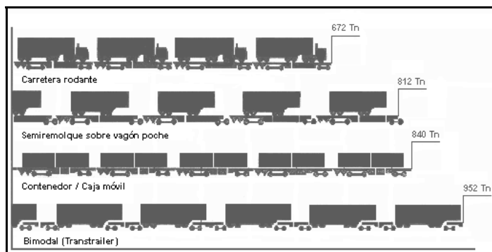
Comparación Bimodal - Sistemas Clásicos: Carga útil para igual peso total (1500TBr)
