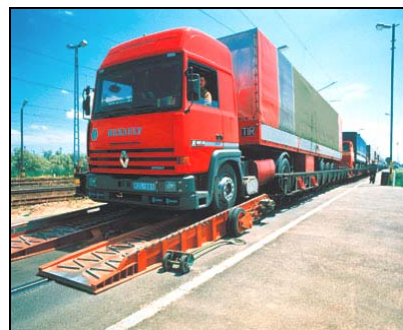
Proceso de descarga de una carretera rodante
