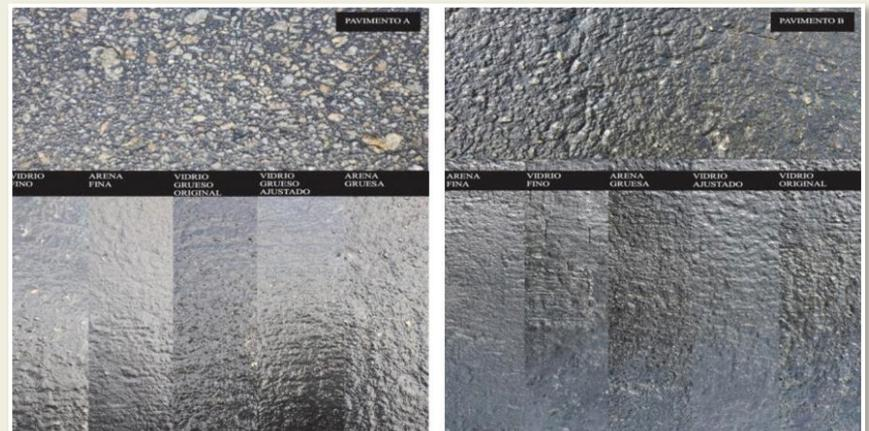
Figura 5. Aplicación de producto sobre pavimento A (izq.) y pavimento B (der.)
