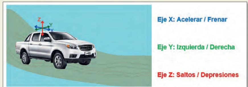
Figura 4. Ejes de medición (Fuente: Elaboración propia)
