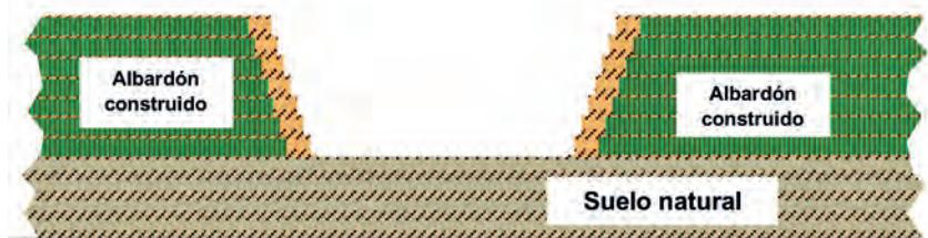
Figura 4.3. SECTOR ABIERTO DURANTE CONSTRUCCIÓN
