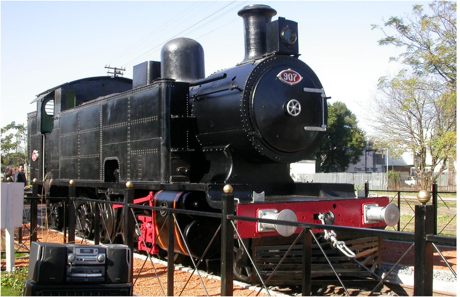
El Ferrocarril Central Argentino clasificó a sus locomotoras de vapor según el servicio que prestaban y de ese modo todas las locomotoras de pasajeros pertenecieron a las Clase P (Passenger), formada por las sucesivas series P1, P2, P3, etc. Del mismo modo las locomotoras de carga fueron Clase C (Cargo), formada por las sucesivas series C1, C2, C3, etc.
