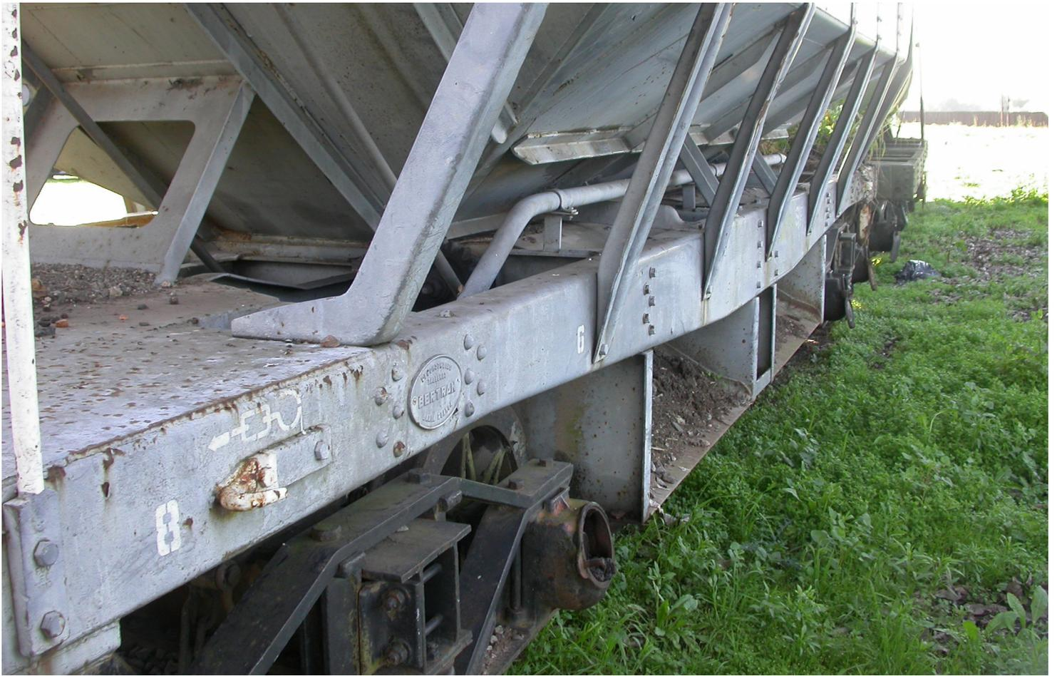
Estaban equipados con freno de sistema vacuo automático (vacío), con un cilindro ubicado en cada balcón, que accionaba la correspondiente timonería de freno de cada bogie y sus cuatro zapatas (una por rueda), contando también con sistema de freno manual de estacionamiento accionado sobre uno de los bogies. Con el tiempo a algunos vagones les retiraron un equipo
