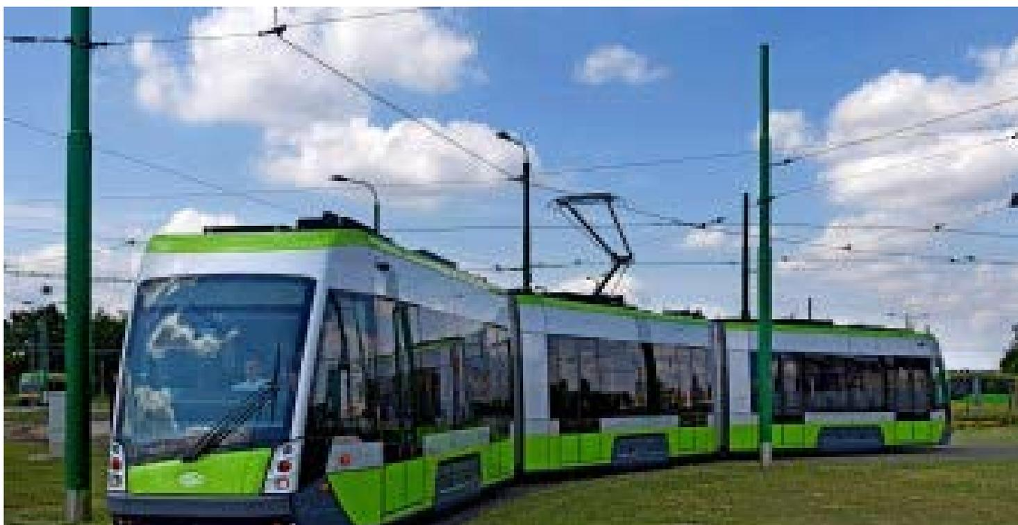
*El tranvía "Solaris Tramino Olsztyn" de Polonia mide 29 m de largo por 2,5 m de ancho y puede llevar 200 pasajeros. Tiene seis puertas dobles que facilitan el acceso y descenso del pasaje. [www.solarisbus.com](http://www.solarisbus.com)*
