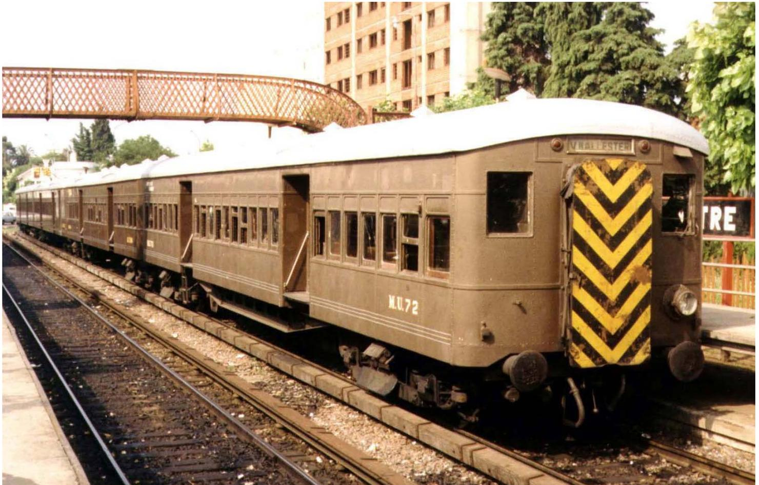
coche, y por poseer los motores enormes bastidores, teniendo los acoplados un bastidor bastante menos significativo. Con los bogies ocurría lo mismo que en sus antecesores de madera, un perfil estructural superior, mayor distancia entre ejes, y ruedas más grandes en los motrices respecto de los portantes.
