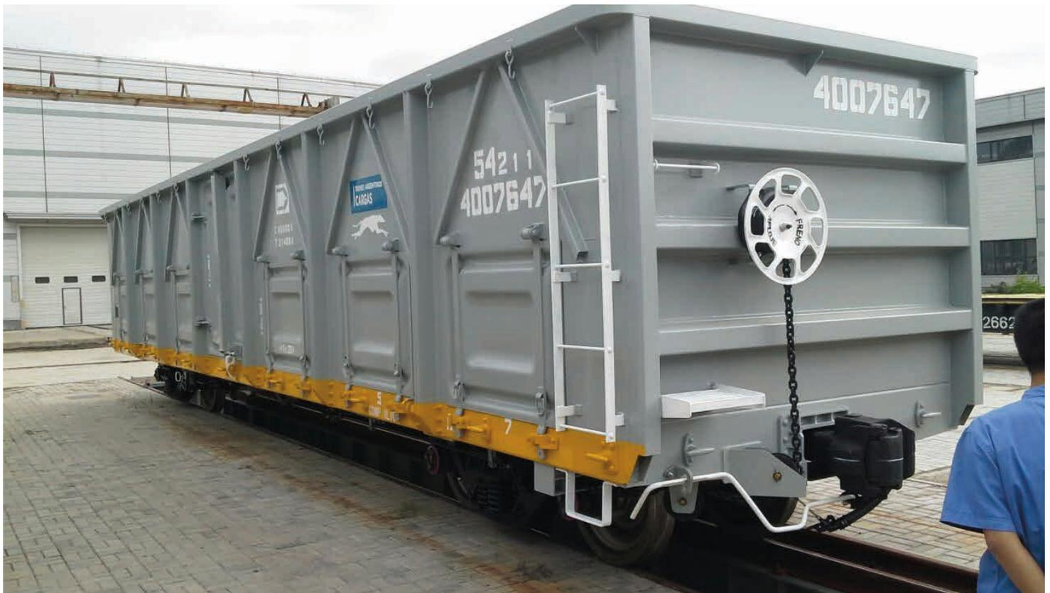
La firma china CRRC ha elaborado las tres primeras muestras de los vagones tolva de descarga lateral que se incorporarán a la Línea Belgrano. Son unidades para 66 toneladas, totalizando un peso en servicio de 87t (22t por eje). Los laterales incluyen dos puertas centrales y seis compuertas de descarga rápida, operadas manualmente. Vienen equipados con bogies Ride control de alta velocidad y frenos de aire comprimido.
