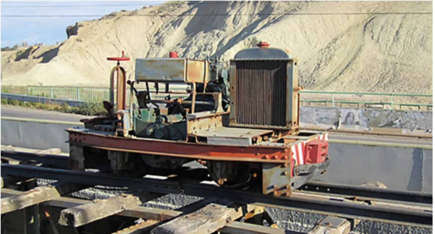
El Simplex 20 hp o "Tractor a Gasolina" no fue el primer tipo de locotractor a explosión pero fue exitoso y su producción muy amplia en la Primera Guerra Mundial. Se lo conoce comúnmente como bow, boat o bent ( "arco", "bote" o "doblado" ) por su característico chasis enmarcado, aunque este tipo no era ni mucho menos la primera locomotora de combustión interna, fué probablemente el primer éxito producido en masa.
