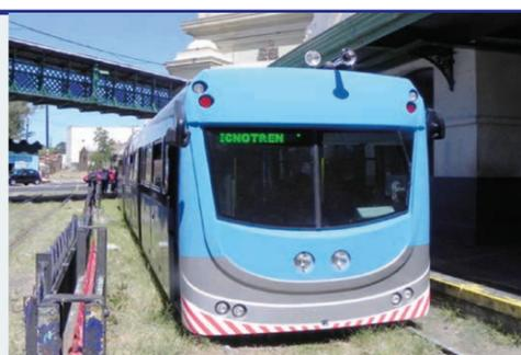
Vehículo ultraliviano ideado especialmente para circular sobre ramales ferroviarios sin uso, o con infraestructura de vías con bajo mantenimiento.
