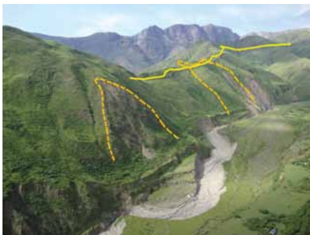
Figura 2. Paisaje característico del extremo este de la Cordillera frontal. Atrás se observa el frente de fracturación principal. En amarillo la línea de gasoducto del tramo 501 a la altura del M+m 105. En líneas de trazo naranja, cicatrices de antiguos deslizamientos.
