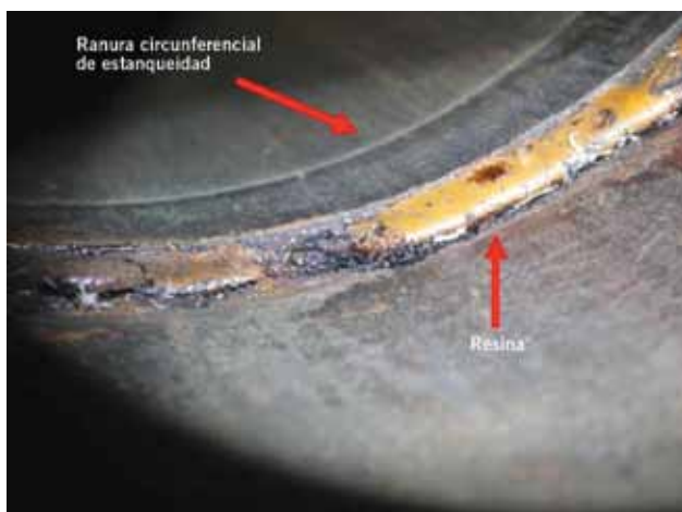
Figura 12. Remanentes de resina epoxi con desprendimiento en el borde 2A. Detrás, el pliego de la ranura de almacenamiento de resina.
