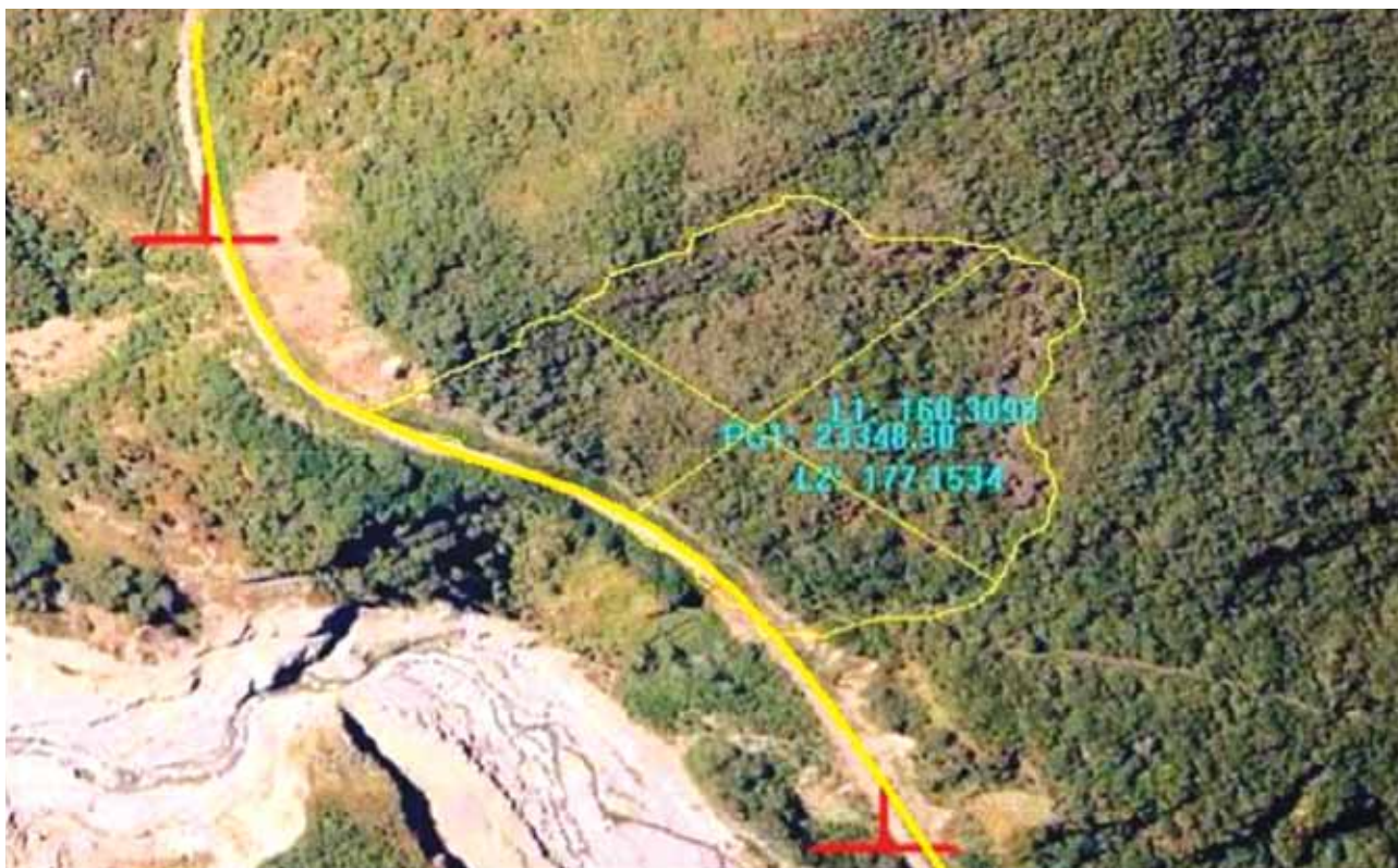
Figura 4, Fotografía aérea escala 1:10.000, que muestra los límites aproximados del talud, la línea amarilla representa el gasoducto.
