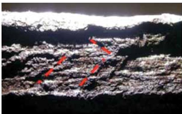
Figura 5. Chevrones identificados en laboratorio. Chevrones.
