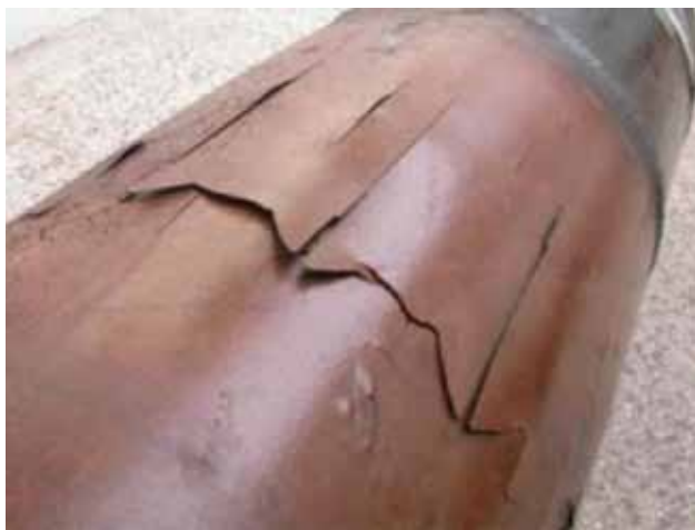
Figura 28. Muestra 2, posensayo. Delaminación del recubrimiento epoxi debido a deformación plástica circunferencial, lado B, similar al de la muestra 1.
