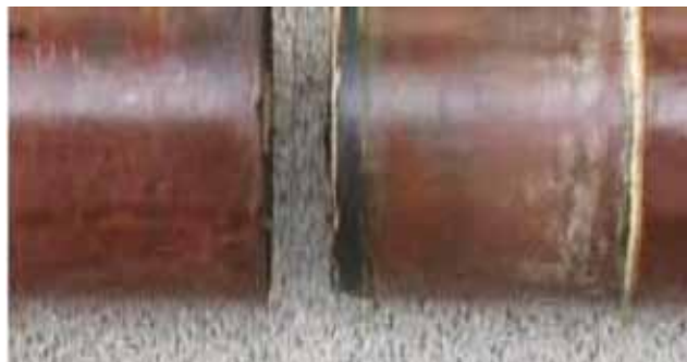
Figura 27. Muestra 2, posensayo. Separación de junta.
