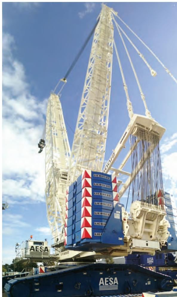
Este nuevo equipo de origen alemán, montado sobre orugas para agilizar su desplazamiento en lugares de trabajo, tiene una capacidad de carga sobresaliente teniendo en cuenta la relación peso/capacidad, pluma variable y sistemas de contrapesos, así como componentes y dimensiones optimizados para simplificar y economizar su montaje y traslado. El peso total de la máquina es de 500 toneladas y colocando los contrapesos suma 850 toneladas.
