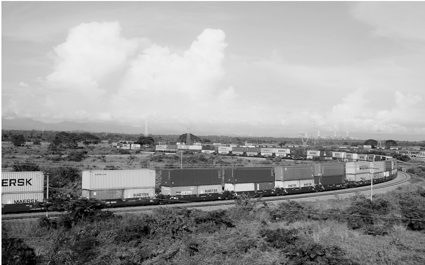
FIGURA 5 | Tren de doble estiba de contenedores en el puerto de Lázaro Cárdenas. México, 2017
