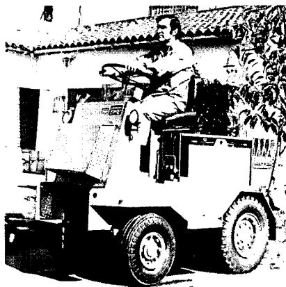
Tractor eléctrico Modelo TEN-12, para remolcar 12.000 kg.
