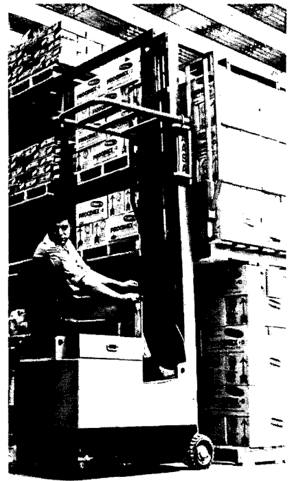
Autoelevador eléctrico Modelo "Junior". Capacidad de carga: 1.000 kg.
