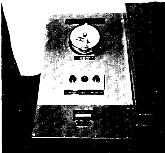
Máquina para crioprecipitado, congelación instantánea -70^{\circ}\text{C} , de 3 a 10 minutos.
