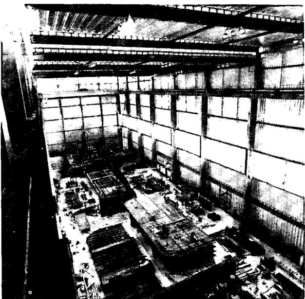
Las chapas de acero naval una vez clasificadas automáticamente en el Parque de Chapas ingresan al Taller de Corte y Soldadura, allí por sistemas también automatizados se cortan y se sueldan grandes conjuntos de chapas.
